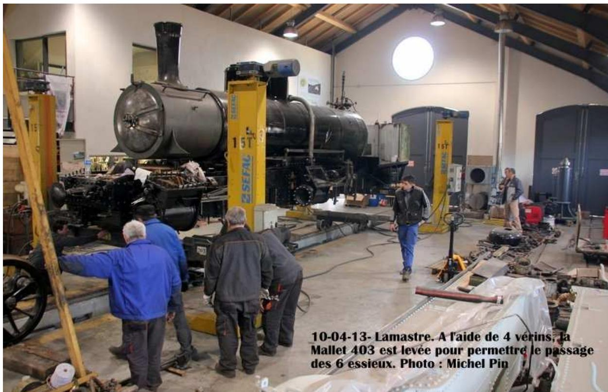
10-04-13- Lamastre. A l'aide de 4 vérins, la Mallet 403 est levée pour permettre le passage des 6 essieux. Photo : Michel Pin
