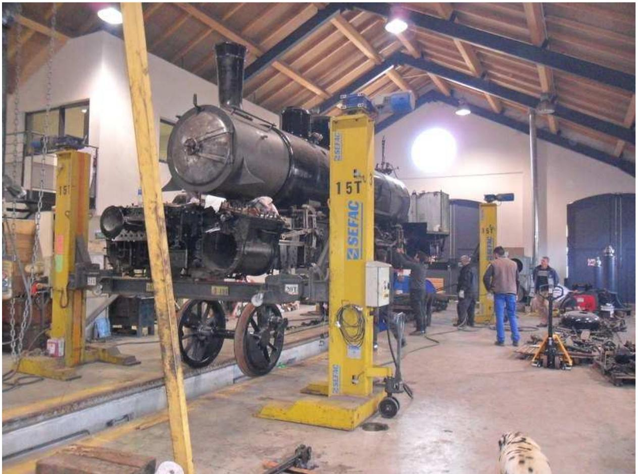
Les essieux sont positionnés un par un sous la machine.
