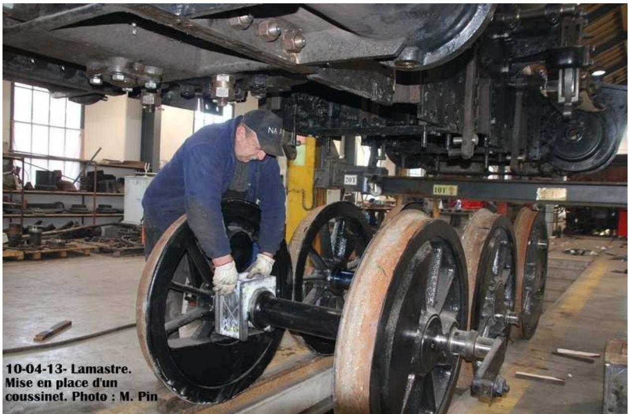
Et on les positionne sur les axes après graissage. La machine est prête à être redescendue.
