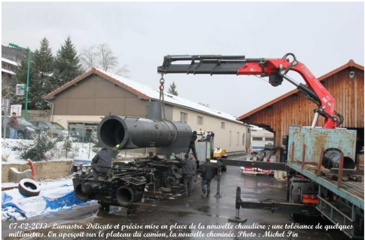
*07-02-2013- Lamastre. Délicate et précise mise en place de la nouvelle chaudière ; une tolérance de quelques millimètres. On aperçoit sur le plateau du camion, la nouvelle cheminée. Photo : Michel Pin*
