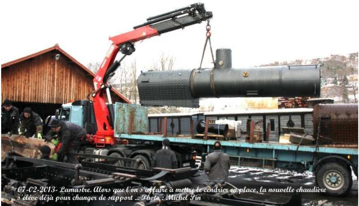
*07-02-2013- Lamastre. Alors que l'on s'affaire à mettre le cendrier en place, la nouvelle chaudière s'élève déjà pour changer de support ... Photo : Michel Pin*
