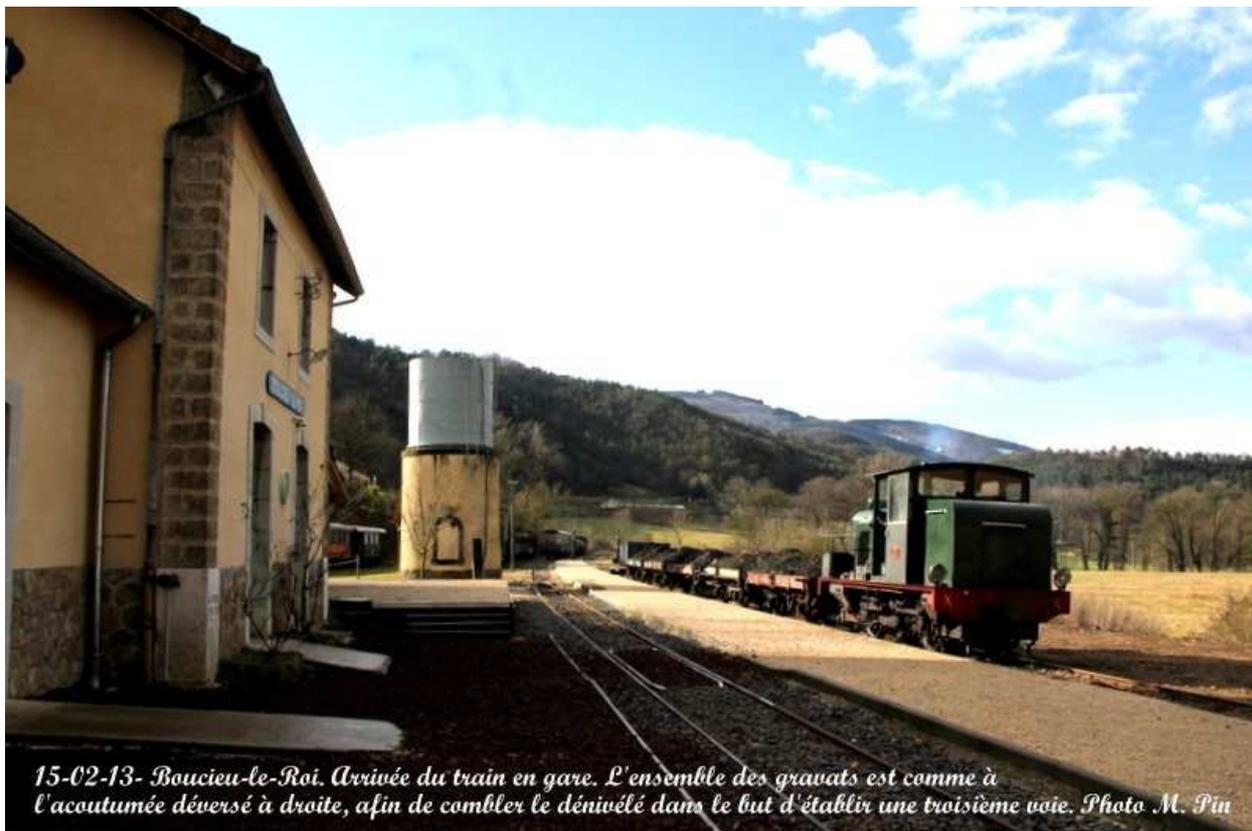
Les gravats sont déchargés sur la partie gauche de la gare pour servir de support à une 3eme voie qui sera posée d'ici quelques jours. Pendant ce temps, c'est les grandes manœuvres à Lamastre. On commence vraiment à manquer d e place.
